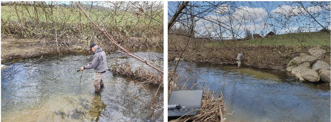
Abb. 3-11: (1) Temperaturlogger in Stahlhülle mit Kette an Holzpfahl in Bachmitte befestigt (zugehöriges Foto links unten), (2) Schwimmender Logger an Schnur an Busch am Gewässerrand befestigt (zugehöriges Foto rechts unten). Abbildungen des Verfassers
