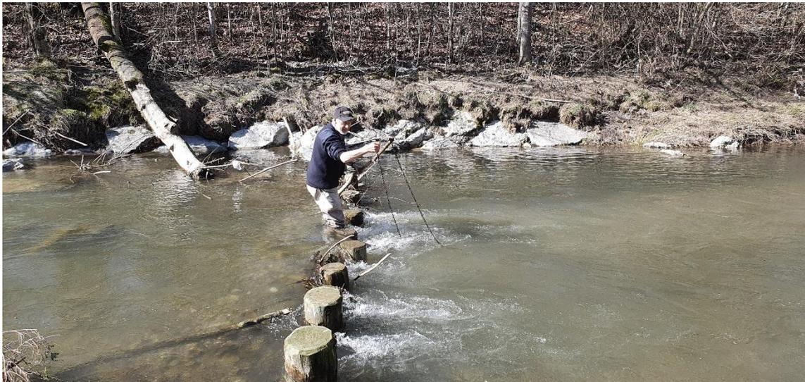
**Abb. 3-9: (1) Temperaturlogger in Stahlhülle mit Kette an Holzpfahl in der Flussmitte liegend (2) Schwimmender Logger an Schnur an Kette befestigt. Abbildungen des Verfassers**
